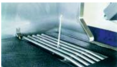
Dipspray-Vorrichtung in der Melkbox integriert
